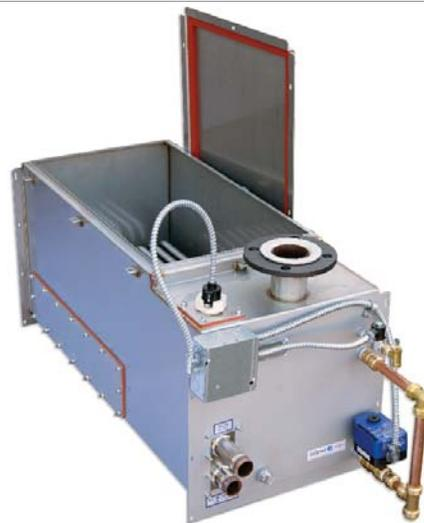
L'umidificatore STS produce vapore per umidificazione privo di sostanze chimiche. STS è stato progettato per l'uso con acqua potabile o acqua addolcita ed è disponibile in opzione per acqua trattata a osmosi inversa o acqua deionizzata (versione DI/RO).
