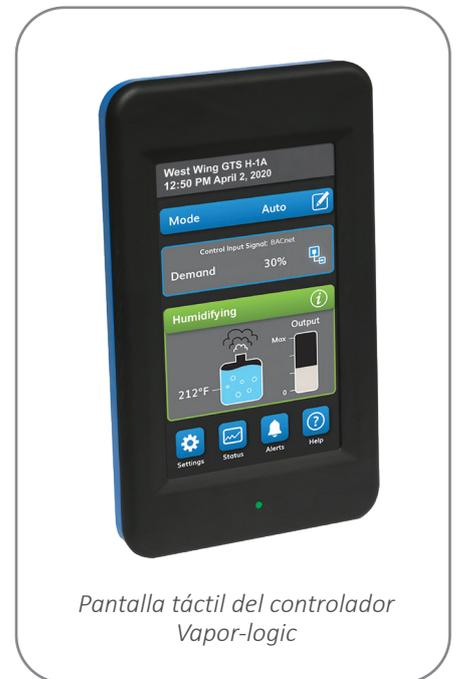
*Pantalla táctil del controlador Vapor-logic*
