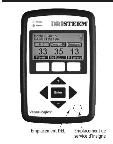
Figure 37-1: Emplacements DEL et affichage d'insigne de service
