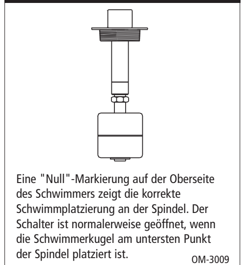
Abbildung 9-2: Schalter zur Abschaltung bei Wasser- mangel für DI/UO-Wassersysteme
