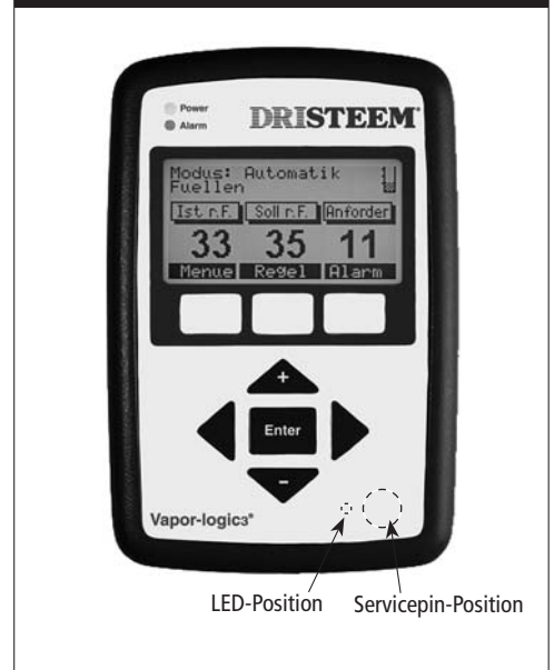
Abbildung 37-1: Positionen von Servicepin und LED am Steuergerät
