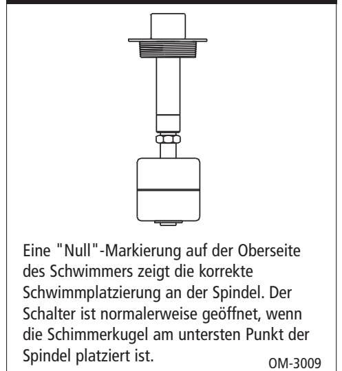
Abbildung 9-2: Schalter zur Abschaltung bei Wassermangel für DI/UO-Wassersysteme
