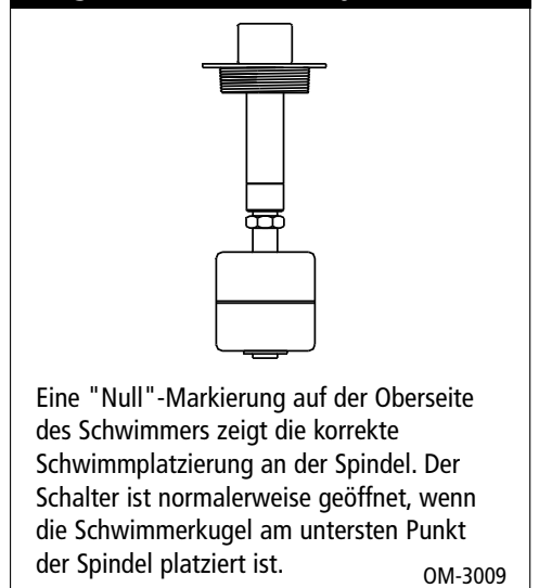
Abbildung 9-2: Schalter zur Abschaltung bei Wassermangel für DI/UO-Wassersysteme
