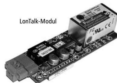
2. LonTalk-Modul in die Pins auf der Vapor-logic4-Platine einstecken.
