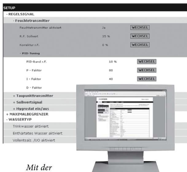
Mit der Vapor-logic4 Steuertastatur oder Standard-Web-Browser-Schnittstelle, wie hier dargestellt, Ihr GTS-Befeuchtersystem steuern.
