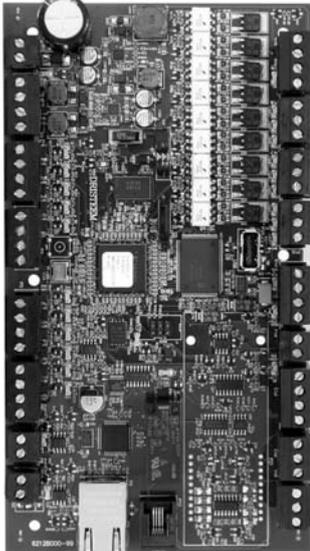
Klemmen P-11 bis P-16 an der Vapor-logic4-Platine weisen eine weiße Umrandung auf. Hier muss der Installateur vor Ort die meisten Verbindungen anschließen.
