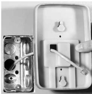
Befestigung an eine Telefonplatte
