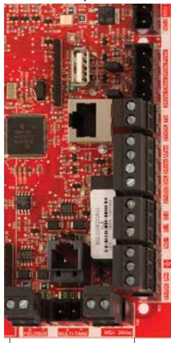
Bornes de branchement sur le terrain. Les bornes P-11 à P-16 ont un bord blanc sur le tableau du Vapor-logic. C'est là que vous effectuerez la plupart des connexions du câblage d'excitation.
