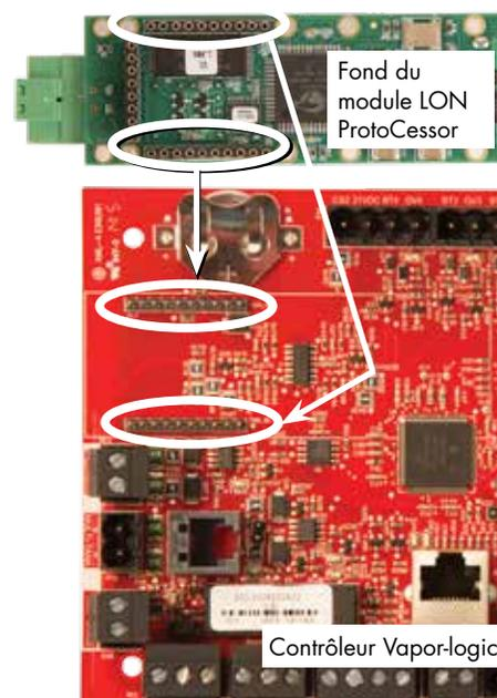
3. Brancher le câblage du système LonTalk au module LON ProtoCessor de la carte Vapor-logic.
