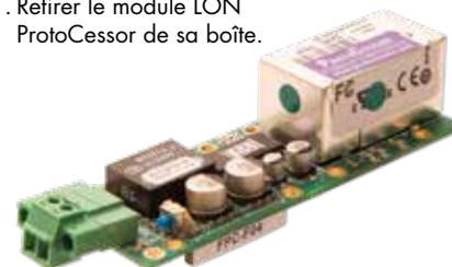
2. Insérer le module LON ProtoCessor dans les broches de la carte Vapor-logic.
