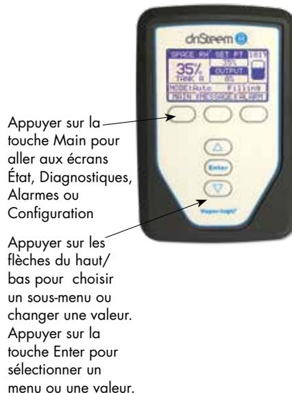
**FIGURE 38-2 :** UTILISATION DE L'INTERFACE WEB DU VAPOR-LOGIC (ÉCRAN ÉTAT ILLUSTRÉ)
