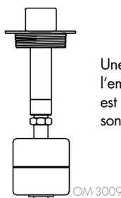
Une marque zéro au dessus du flotteur indique l'emplacement correct de fixation à la tige. L'interrupteur est normalement ouvert lorsque le flotteur à boule est à son point le plus bas de la tige.
