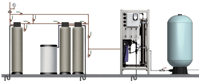
Systém DriSteem s dechlorátorem, změkčovačem vody, systémem reverzní osmózy a zásobníkem.
