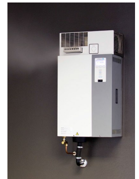
등온식 (증기) 가습기: 가습기 탱크 내에서 물을 끓여 증기를 생성하고 이를 스팀 매니폴드를 통해 덕트내부로 배출하거나 직접 공간 안으로 분배합니다.
