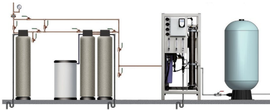
DriSteem 시스템은 탈염기, 연수 조절 장치, 역삼투 시스템 및 저장 탱크를 갖추고 있습니다.
